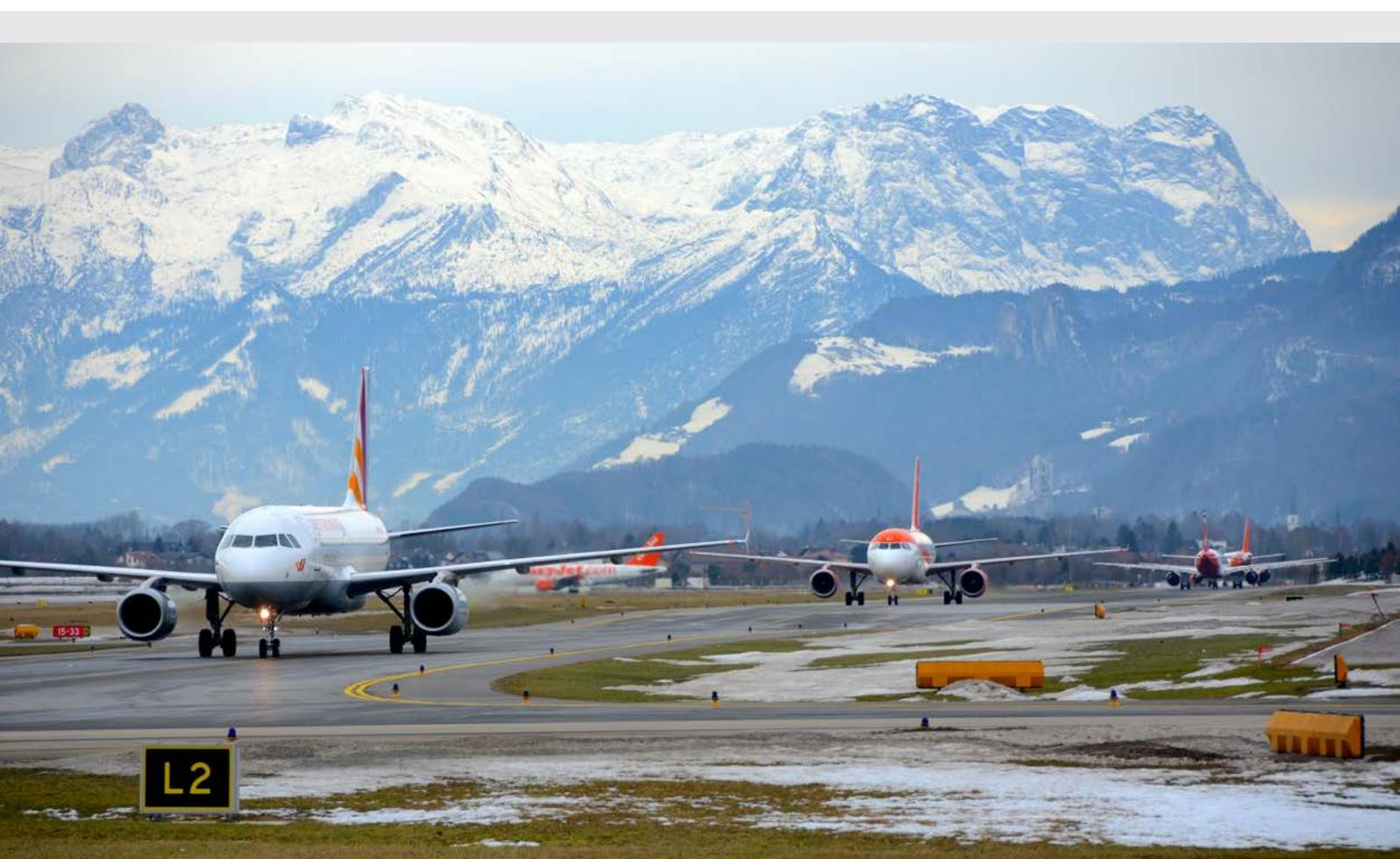
Bei einigen Flughäfen, wie hier in Salzburg, verhindert die Topografie die Einrichtung von Präzisionsanflugverfahren für alle Pisten.
